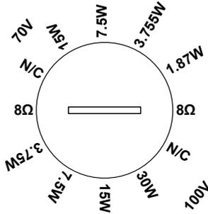
**Brancher les deux fils à la sortie de votre amplificateur et sélectionner la puissance désirée.**
