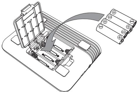
**Nota:** Cuando las pilas se estén agotando, **BATT** parpadeará en la pantalla. Por favor, reemplace las pilas.
