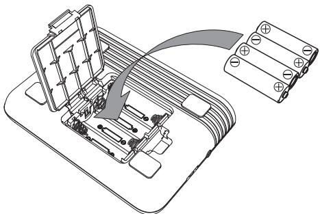
**Note:** 電池の残量が減るとディスプレイに **BATT** の文字が点滅します。電池を交換してください。
