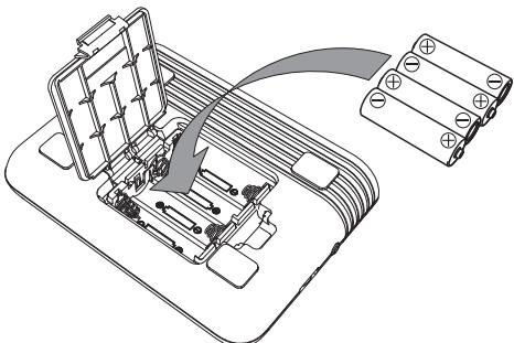
**Hinweis:** Wenn die Batterien des Gerätes fast erschöpft sind, blinkt das Display **BATT**. Tauschen Sie die Batterien gegen neue aus.
