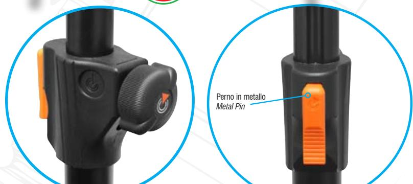
Meccanismo con pulsante di blocco automatico che permette il sollevamento del tubo ma non ne permette la discesa. Per sbloccare il tubo è necessario premere il pulsante stesso.
