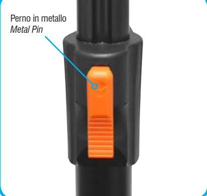
Meccanismo con pulsante di blocco automatico che permette il sollevamento del tubo ma non ne permette la discesa. Per sbloccare il tubo è necessario premere il pulsante stesso.
